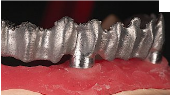
Abb. 18: Gute Passform des SLM gefertigten Kobalt-Chrom Gerüsts.
